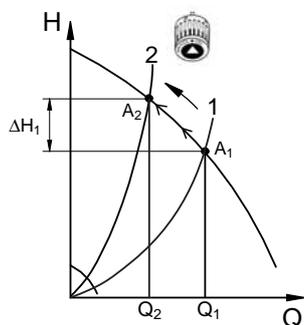
Fig. 7 Pompa non controllata (a velocità fissa)
