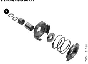
Fig. 15 Vista esplosa della tenuta meccanica
