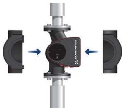
Fig. 18 Montaggio gusci isolanti su pompa MAGNA1
