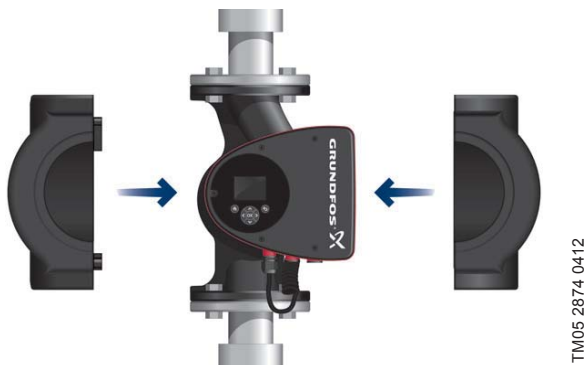
Fig. 47 Montaggio gusci isolanti su pompa MAGNA3
